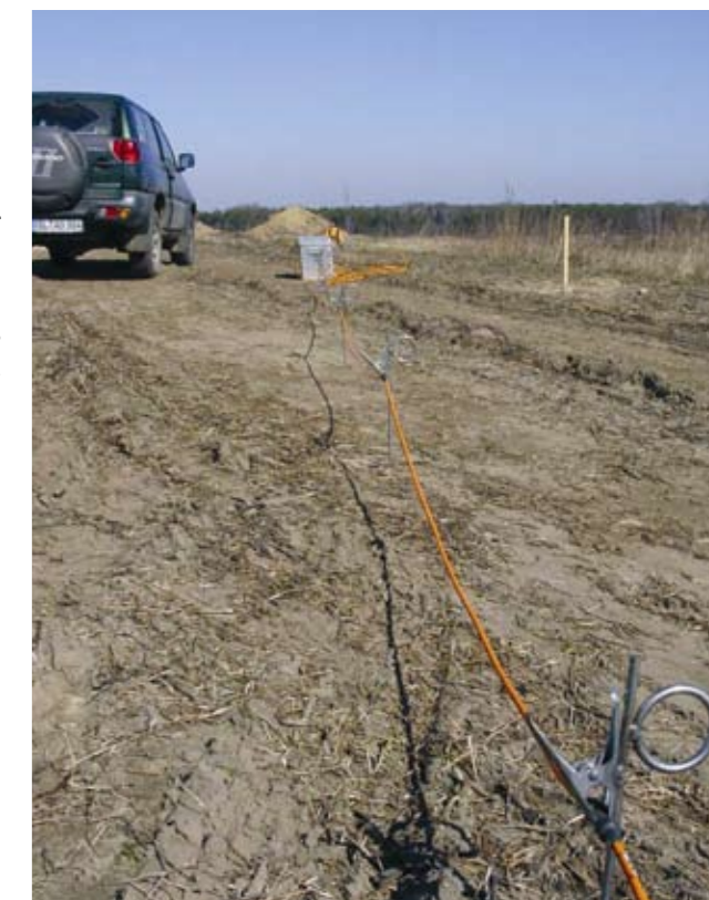
Geoelektrische Messung (Foto: GMB)
