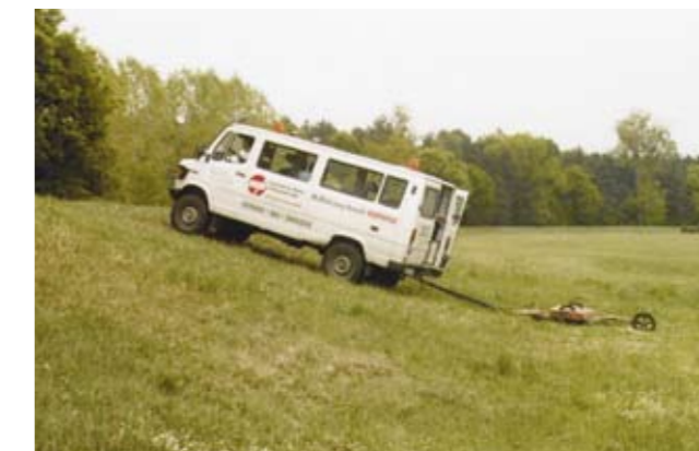
Georadarmessungen im Gelände (Foto: GMB)
